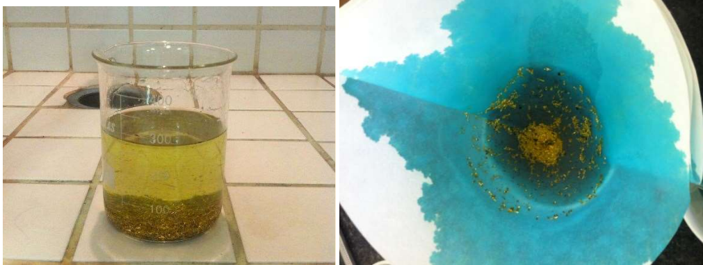
Figura 3a (esquerda). Pinos no ataque ácido. Figura 3b (direita). Filtragem do ácido após o ataque, mostrando as folhas metálicas.
